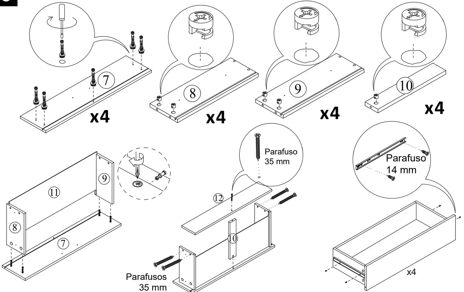
Instale as calhas das gavetas de acordo com as posições dos furos marcados!
